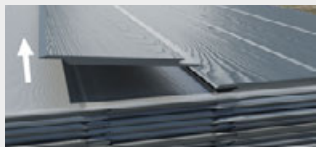
Hardie® VL Plank Fassadenplatten werden ineinander gesteckt geliefert. Paneele sind bei der Entnahme von der Palette seitlich herauszuziehen und erst dann anzuheben.
