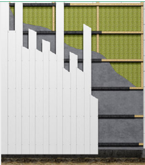
Anordnung der Boden-Deckel-Schalung.
